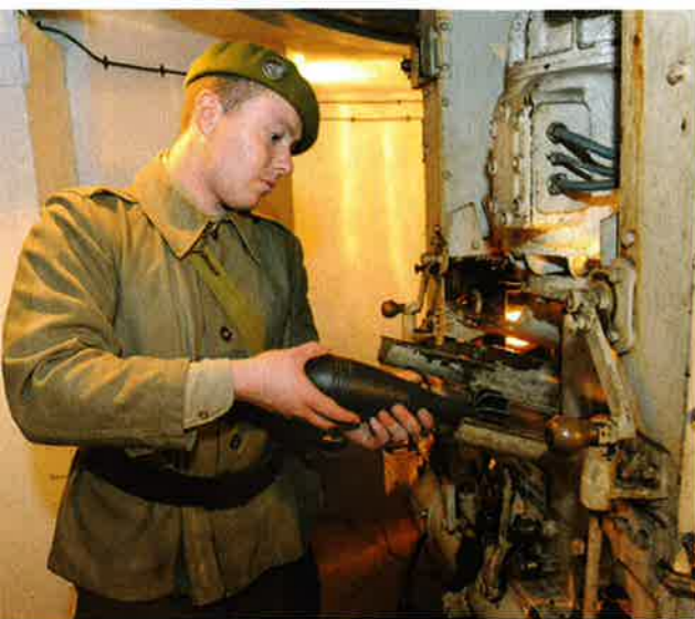
Tourelle de mortier de 81 mm : chargement en projectiles de la noria d'approvisionnement par du personnel du 151 e RAP.
