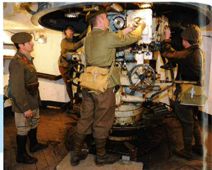
Tourelle de mortier de 81 mm : chargement en projectiles de la noria d'approvisionnement par du personnel du 151 e RAP.
